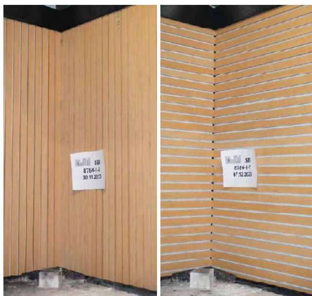
Figur 1: Prøvemontering i SBI – Vertikal og horisontal orientering af lameller.
