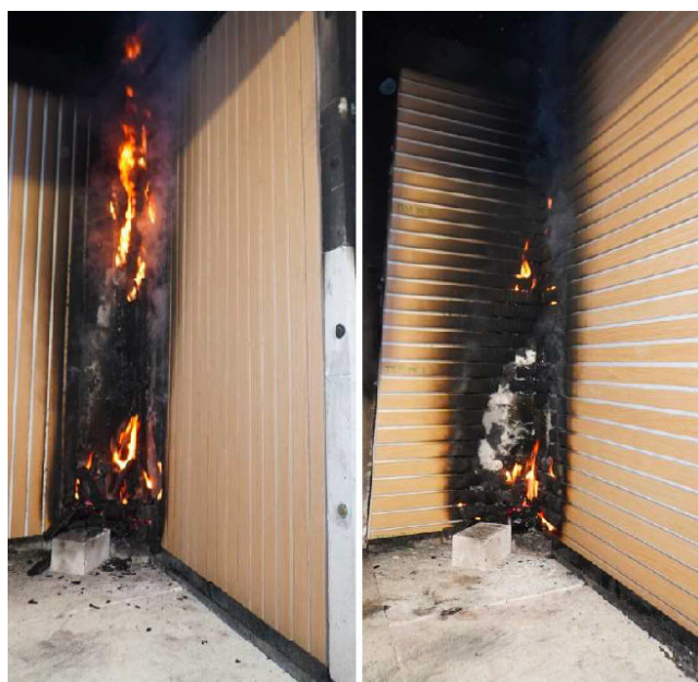
Figur 2: Prøver (Nr. 8784-1-3 og 8784-1-7) efter testen.
