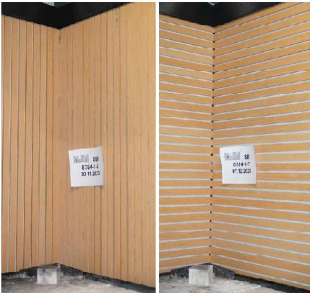
Figura 1: Montaje de prueba en SBI - Orientación vertical y horizontal de las láminas.
