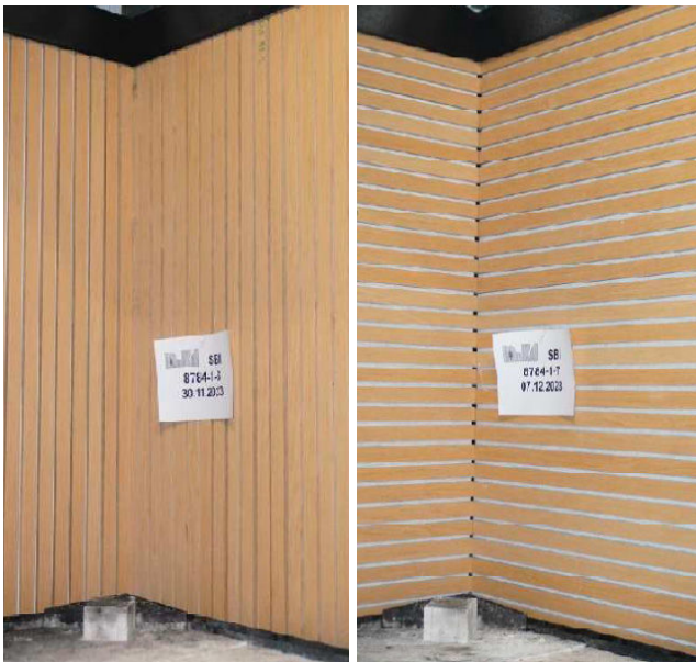
Figura 1: Montaggio di prova a SBI - Orientamento verticale e orizzontale delle lamelle.
